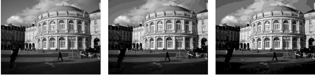
FIG. 3 – Effet de la quantification sur les images. De gauche à droite et de haut en bas. Image originale avec 256 niveaux de gris, puis respectivement 20, 10 et 5 niveaux de gris. Les effets de quantification sont très visibles à 20 niveaux de gris et la qualité désastreuse à 5. En revanche, il n’y a aucun problème à interpréter la plupart des formes.
